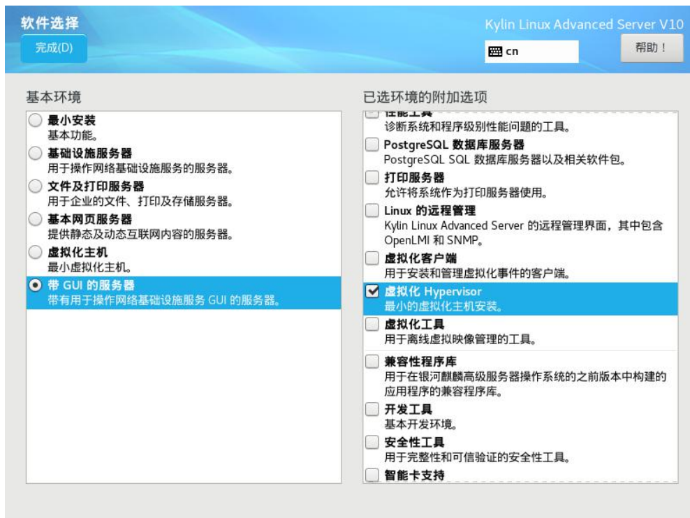
图 7-1 安装虚拟化软件包选择
