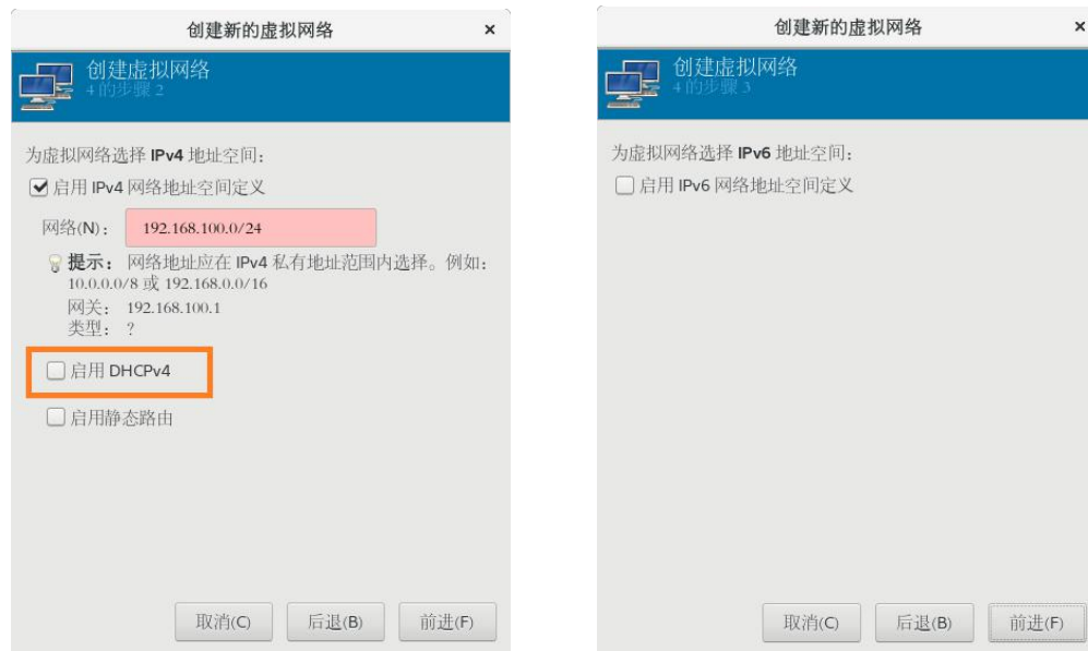
图 7-24 设置虚拟网络 IP
